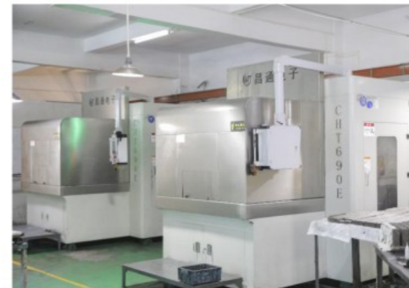
多线切片机 Multiline slicer
