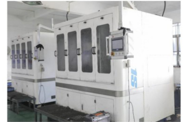
多线切片机 Multiline slicer
